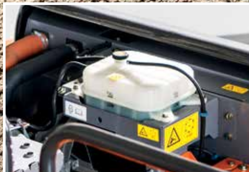
Zbiornik wyrównawczy zapobiega przegrzewaniu się części silnika.
