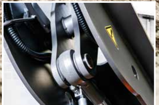
Le tubazioni sistemate all'interno del braccio sono ben protette.
