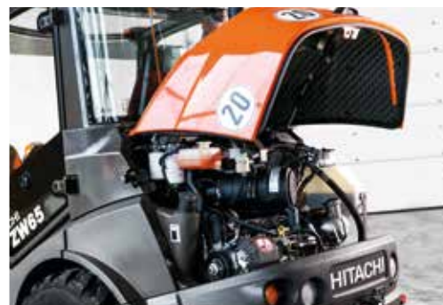
Il cofano motore facile da aprire consente di accedere rapidamente ai componenti.
