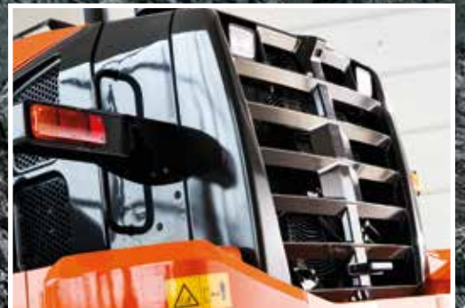
I radiatori anti-intasamento opzionali aumentano la durata della macchina.
