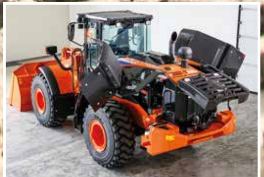
Facilità di accesso per la manutenzione da terra.
