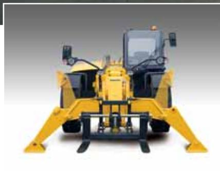
Los estabilizadores de tipo ancho garantizan la máxima estabilidad en cualquier tipo de terreno. Los cilindros quedan perfectamente protegidos dentro del bastidor.
