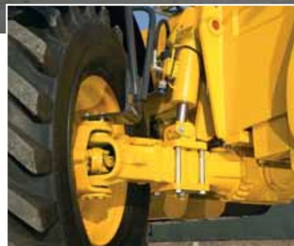
El bloqueo automático de oscilación del eje trasero opcional aumenta la superficie de apoyo, incrementando así tanto la capacidad de elevación como la seguridad, a la vez que se reduce el riesgo de vuelco lateral. Se activa automáticamente cuando el ángulo de elevación es superior a 50°.
