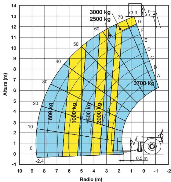
**Sobre neumáticos con bloqueo del eje trasero**
