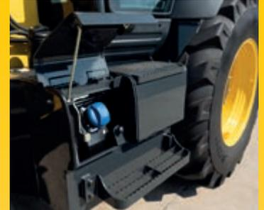
AdBlue®, Kraftstoff und Hydrauliköl können an der Seite der Maschine bequem vom Boden aus aufgefüllt werden
