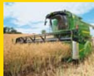
**RapsProfi II.** I semi di colza possono essere difficili da raccogliere: gli steli sono intrecciati tra di loro e i baccelli scoppiano quando vengono colpiti dalla barra di taglio. L'estensione di taglio è in grado di ridurre sensibilmente le perdite per ettaro. In questo modo è possibile recuperare il denaro investito per questo sistema in pochissimo tempo. Montaggio semplice, senza bisogno di attrezzi.
