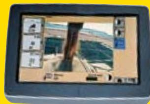
La funzionalità video integrata nel display GreenStar 3, in presenza di una telecamera installata, consente di vedere la parte posteriore della mietitrebbia, la tramoggia o la coclea di scarico, offrendo visualizzazioni eccellenti e personalizzabili a seconda delle esigenze.
