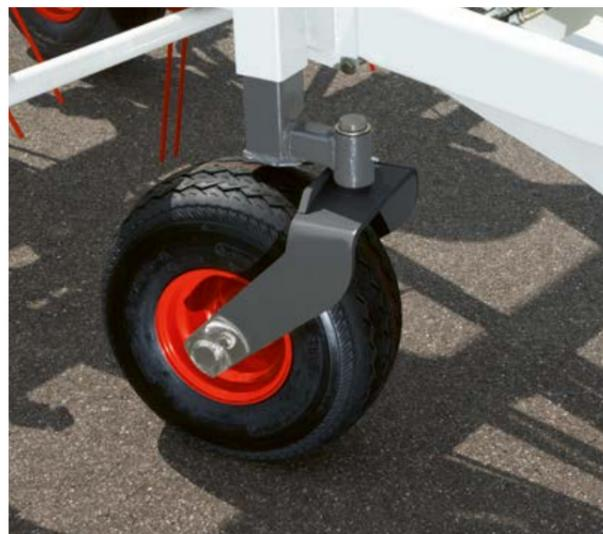
Adaptation optimale au sol grâce à la roue de jauge en option.
