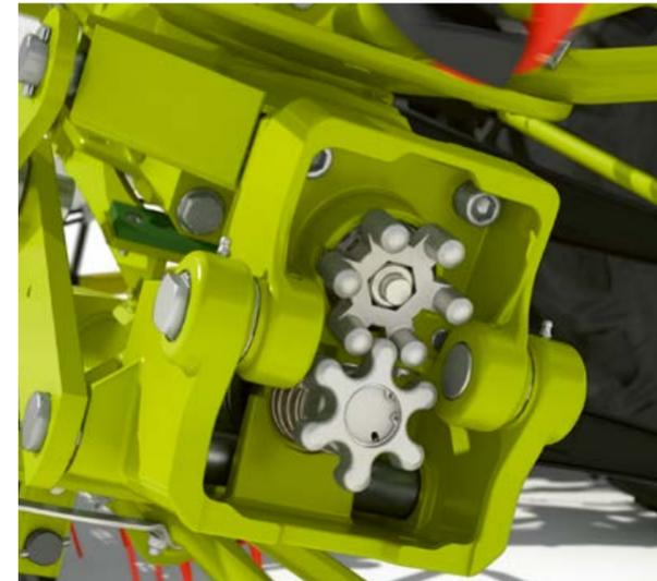
Transmission de puissance brevetée : le système d'entraînement à doigts PERMALINK.
