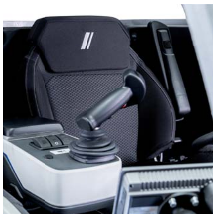
Joystick z ergonomicznie rozmieszczonymi elementami sterującymi
