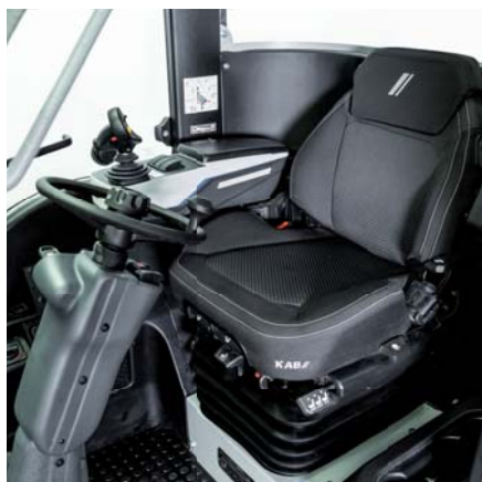
Zamknięta kabina kierowcy z komfortowym fotelem z zawieszaniem pneumatycznym, ogrzewaniem siedzenia i amortyzacją wzdłużną
