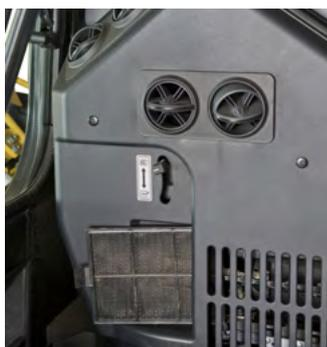
I filtri dell'aria sono facilmente accessibili per facilitare la manutenzione.
