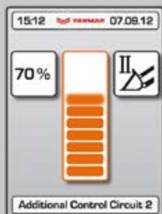
Ajustement proportionnel électrique de la performance hydraulique des 3 e et 4 e circuits.
