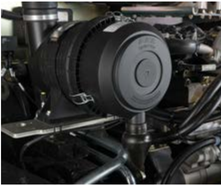
Filtration moteur optimisée par une double filtration.
