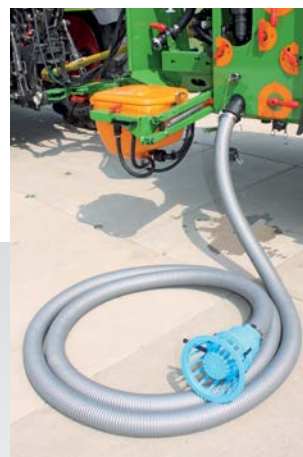
Llenado a través de manguera de aspiración
