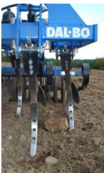
**Tri-Max** kann mit hydraulischen 2-D Zinken ausgerüstet werden. Die Zinken können ca. 20 cm horizontal und ca. 30 cm vertikal ausweichen.
