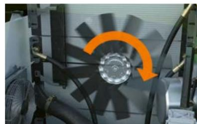
Im Uhrzeigersinn: Luft wird zurückgeblasen
