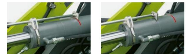
Dank mechanischer Neigungsanzeige haben Sie den Kippwinkel des Anbaugeräts immer im Blick.
