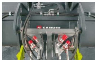
Sämtliche Hydraulikan-schlüsse liegen gut erreichbar und dennoch geschützt am Geräteträger.
