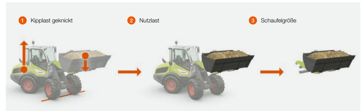
Kipplast geknickt nennt man diejenige Last im Lastschwerpunkt des Anbaugerätes, die den Radlader über die Vorderachse zum Kippen bringt. Dabei befindet sich die Maschine in der für sie statisch ungünstigsten Position: Das Hubgerüst ist waagrecht ausgefahren, der Radlader voll eingeknickt.
