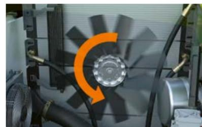
Gegen den Uhrzeigersinn: Luft wird angesaugt
