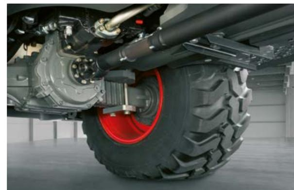
Hydrostatisches Getriebe mit selbsthemmender Bremswirkung
