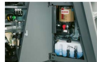
Die Vorratsbehälter für die Zentralschmieranlage und die Scheibenwischanlage sind im Einstiegsbereich gut sichtbar.
