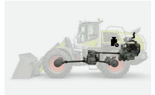
Motoreinbaulage TORION 1914-1177: optimale Gewichts- verteilung durch einzigartige Einbaulage von Motor und zuge- hörigen Komponenten.
