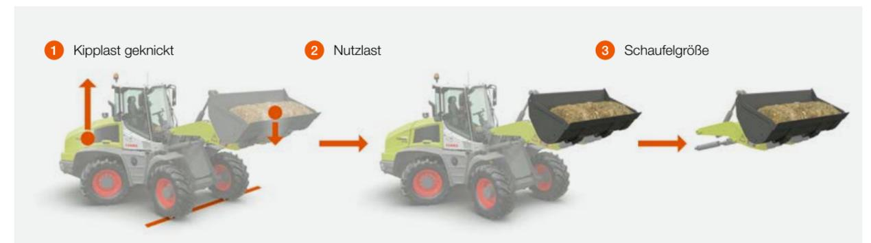
Kipplast geknickt nennt man diejenige Last im Lastschwerpunkt des Anbaugerätes, die den Radlader über die Vorderachse zum Kippen bringt. Dabei befindet sich die Maschine in der für sie statisch ungünstigsten Position: Das Hubgerüst ist waagrecht ausgefahren, der Radlader voll eingeknickt.
