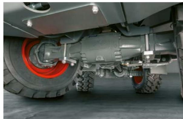
Sobald der Fahrer über das Lenkrad den Radlader einknickt, lenkt die Hinterachse synchron mit.
