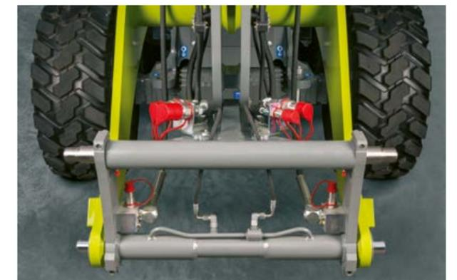
I modelli TORION 644 e 537 SINUS sono dotati del porta-attrezzi già montato sulla serie più piccola delle TORION.
