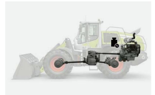
Posizione di montaggio del motore sulla TORION 1914-1177: distribuzione ottimale del peso grazie all'intelligente posizione di montaggio del motore e dei relativi componenti.
