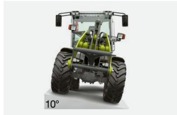
Il robusto giunto articolato oscillante con un angolo di oscillazione del 10° compensa le irregolarità del suolo, assicurando una grande stabilità e un alto comfort di guida.
