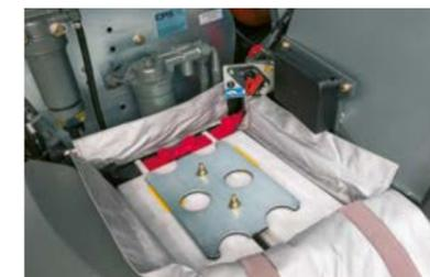
La batteria e l'interruttore principale sono facilmente accessibili sulla TORION 1511-1177.
