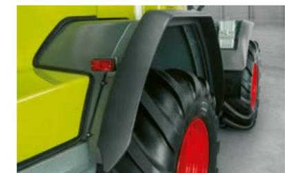
TORION 1511-1177: allargamento passaruota posteriore per pneumatici di 750 mm di larghezza
