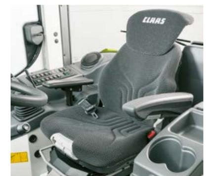
Sedile pneumatico e riscaldato con schienale alto
