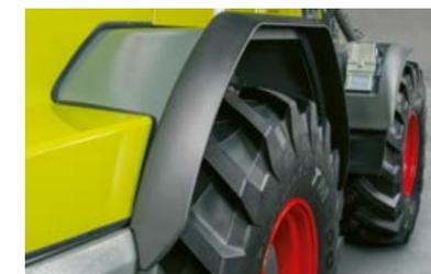
TORION 1511-1177: allargamento passaruota posteriore per pneumatici di 620 mm di larghezza
