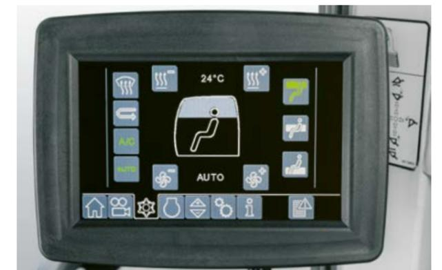
Il climatizzatore può essere controllato, a scelta, tramite tastiera a membrana o display tattile.
