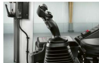
Il rientro automatico della benna può essere attivato premendo un pulsante sul joystick.
