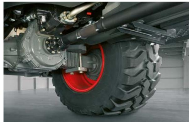
Trasmissione idrostatica con azione frenante autobloccante
