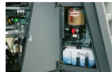
Il serbatoio dell'impianto di lubrificazione centrale e l'impianto lava-vetri sono posizionati in modo ben visibile nell'area di accesso.
