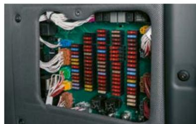
Sistema elettrico centrale di base in un vano protetto.
