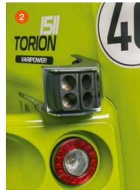
La distanza dall'ostacolo viene indicata con l'ausilio di diodi luminosi a colori (3). Non appena viene rilevato un ostacolo, viene emesso un segnale d'avvertimento all'interno e all'esterno della cabina (TORION 1914 / 1812).
