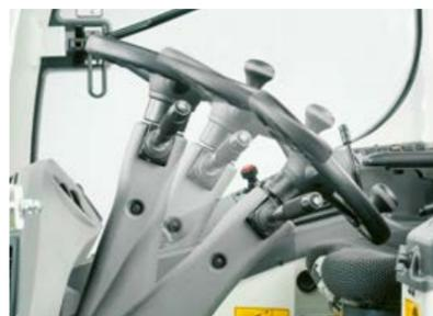
Possibilità di regolare in continuo l'inclinazione della colonna dello sterzo
