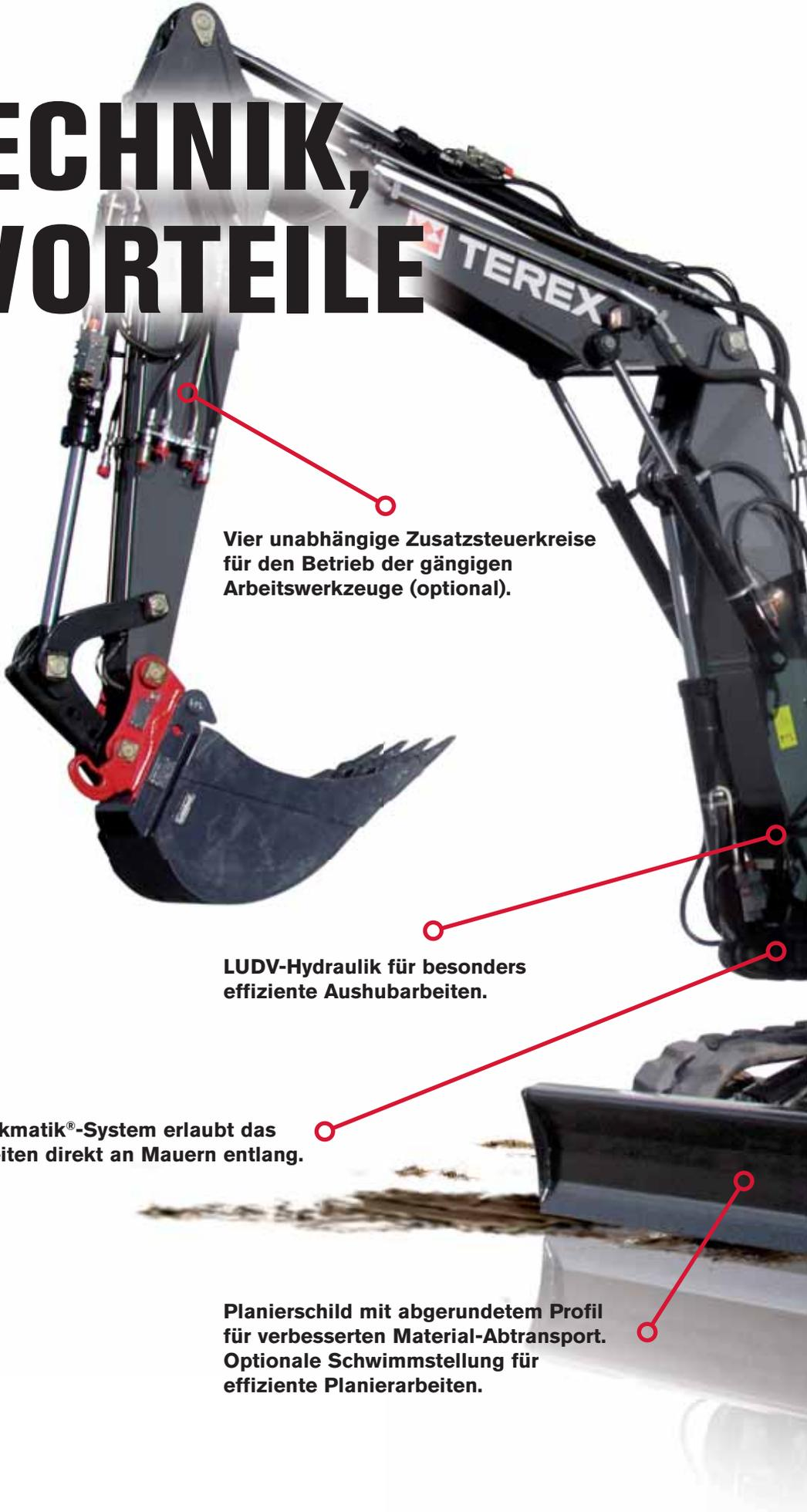
Vier unabhängige Zusatzsteuerkreise für den Betrieb der gängigen Arbeitswerkzeuge (optional).
