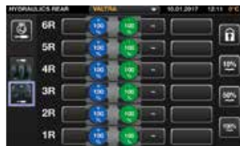
Możliwość sterowania elementami układu hydraulicznego, w tym zaworami hydraulicznymi (przednimi i tylnymi), podnośnikami (przednim i tylnymi) oraz ładowniczem czołowym.
