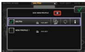
Profile operatorów i osprzętu z możliwością łatwej zmiany z poziomu dowolnego menu ekranowego. Wszystkie zmiany ustawień zostają zapisane w wybranym profilu.
