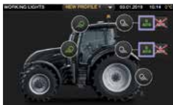
Las luces de trabajo son fáciles de configurar con la pantalla táctil de 9". También en el reposabrazos hay botones de encendido / apagado para las luces de trabajo y el rotativo.
