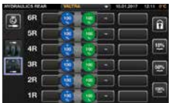
Puede asignar cualquier control para trabajar con cualquier válvula, incluidas las válvulas hidráulicas delanteras, traseras, el elevador delantero, el elevador trasero y el cargador frontal.
