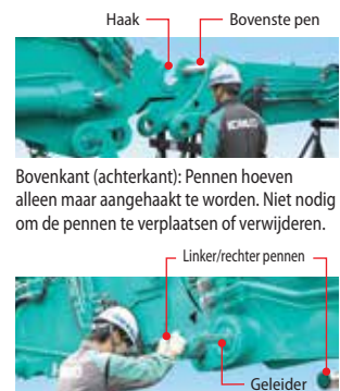
Onderkant: Geleide, tegengestelde linker- en rechterpen vergemakkelijken het positioneren van de pennen.
