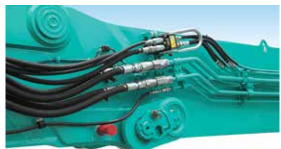
Aansluiting leidingen: hydraulische multi-koppeling aan zijkant van giek.
