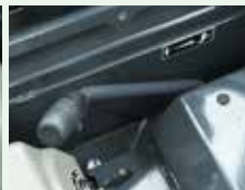
Accélérateur équipé d'un contacteur petite/grande vitesse de translation
