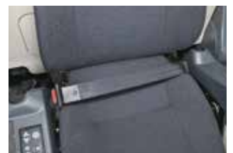
Automatikgurt erfordert keine manuelle Einstellung
