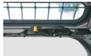
Entriegelung per Knopfdruck für einfaches Öffnen und Schließen der Frontscheibe
