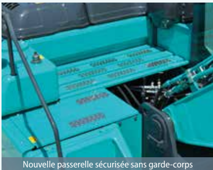
Nouvelle passerelle sécurisée sans garde-corps
