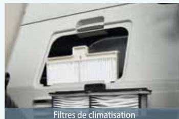
Filtres de climatisation
