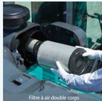
Filtre à air double corps
