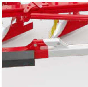
Hydraulicky nastavitelný záběr prvního tělesa
