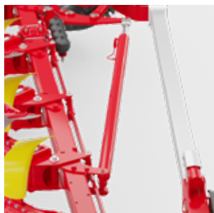
Hydraulicky nastavitelný záběr pluhu
