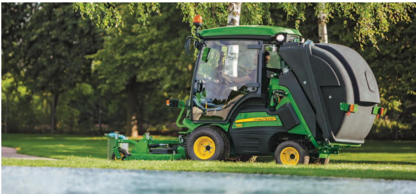
Il nuovo sistema di raccolta GLC1500 raccoglie efficacemente il materiale grazie alla nuova potente valvola integrata a comando idraulico che assicura un flusso costante. Il sistema idraulico garantisce anche elevate velocità di sollevamento e abbassamento per uno svuotamento più rapido del cesto raccogliherba quando è pieno. Se la capacità di raccolta di serie (600 l) non vi basta, provate la versione da 900 l.
