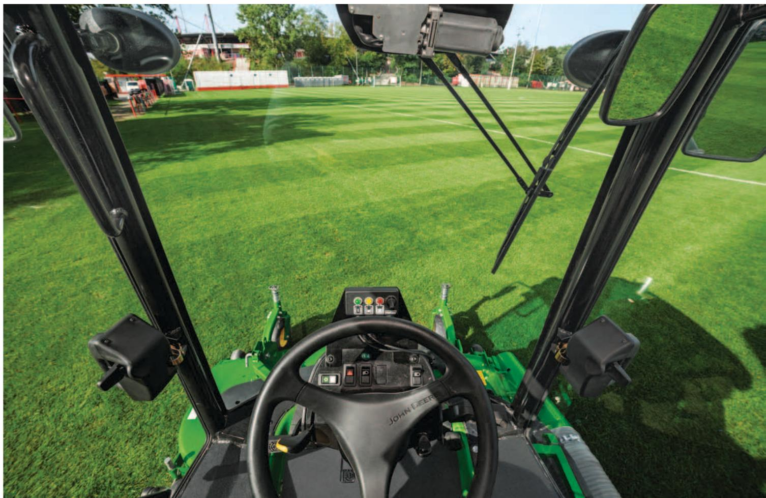
Una soluzione cabina completamente integrata che combina una serie di caratteristiche innovative fornendo all'operatore un ambiente di lavoro di prima classe. Completamente incorniciata da vetro curvato per una visibilità a 360 gradi e con un interno molto spazioso, la cabina comfort costituisce inoltre un ambiente di lavoro estremamente silenzioso, in parte grazie ai tappetini insonorizzanti in gomma. La macchina lavora duramente mentre voi vi godete ogni comfort.
