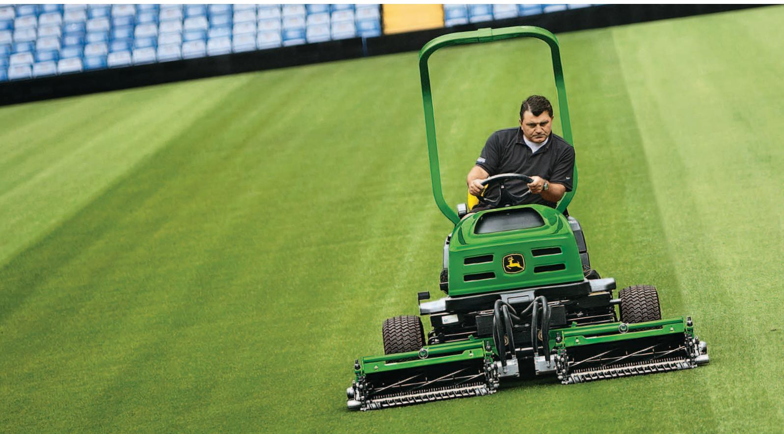
I modelli John Deere 2653B e 7200 A sono adatti per ottenere un eccellente taglio di finitura a cilindri elicoidali. Progettate per combinare elevate prestazioni, affidabilità e semplicità di utilizzo, queste macchine offrono anche una grande semplicità di manutenzione. Se avete bisogno di ancora più potenza, il modello 7200 A è quello che fa per voi, grazie alla possibilità di modificare la larghezza di taglio a seconda del lavoro da svolgere.
