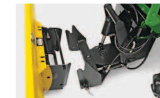
**Lame pour attelage rapide John Deere** : pour le déneigement ou le nivellement.
