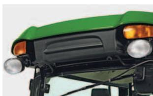
**Phares de travail arrière** : option idéale pour les applications utilisant des outils montés à l'arrière.
