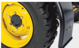
**Ailes avant** : pour une protection optimale du poste de travail ou des vitres de la cabine contre les saletés et la boue.
