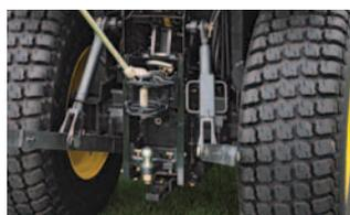
**Attelage arrière réglable en hauteur** : réglage aisé de la hauteur pour toutes les remorques à attelage à chape et rotule.
