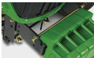
**Masses avant** : masses individuelles à poignée intégrée pour une mise en place et une dépose facilitées.
