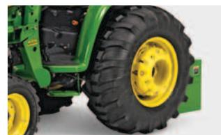
**Masses pour roues arrière** : améliorent la motricité sur terrain glissant, lors des travaux au chargeur ou des opérations de déneigement.
