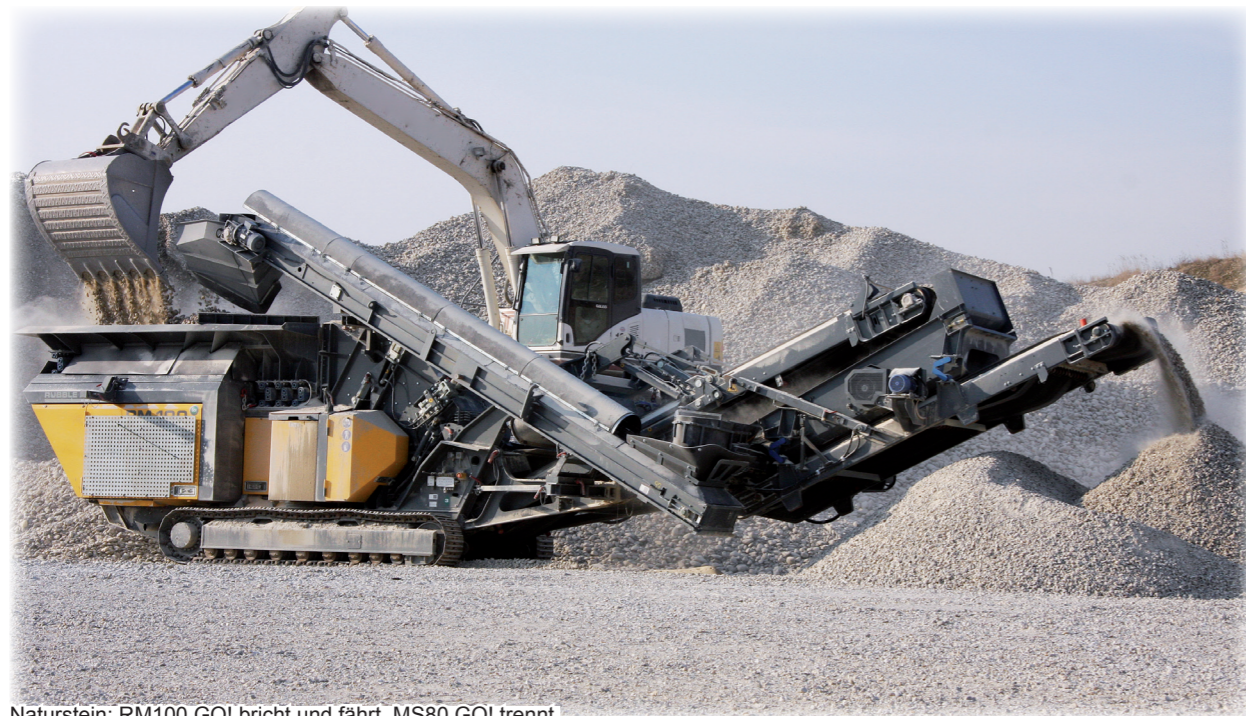
Naturstein: RM100 GO! bricht und fährt, MS80 GO! trennt.
