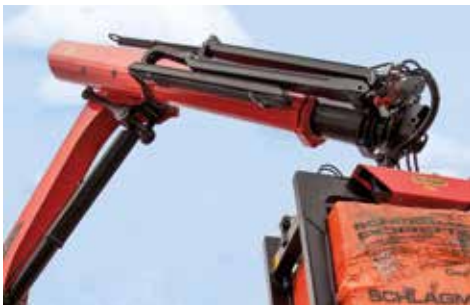
P-PROFIL ERHÖHUNG DER STEIFIGKEIT BEI GLEICHZEITIGER GEWICHTSREDUKTION
