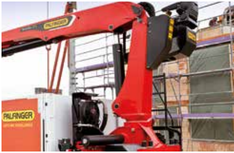
INNENLIEGENDE SCHLAUCHFÜHRUNG VERMEIDUNG VON BESCHÄDIGUNG
