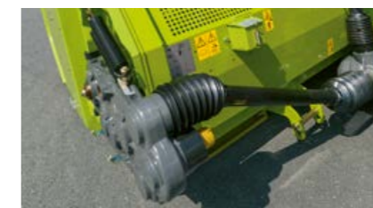
Leistungsstarker Antriebsstrang mit dreistufigem Getriebe.
