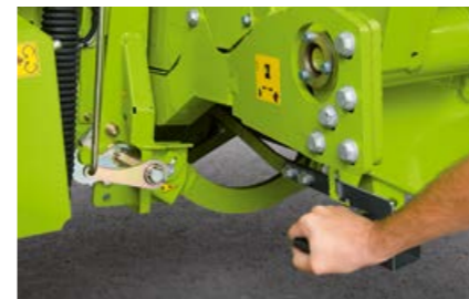
Zweistufige Drehzahlanpassung der Einzugskegel bei ORBIS mit T-Antrieb.
