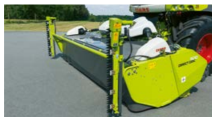
DIRECT DISC 600 / 500: Seitentrennmesser, optional mit integriertem hydraulischen Antrieb.
