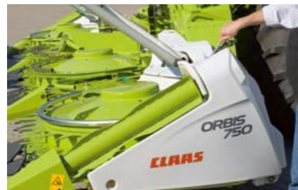
Im Bedarfsfall wird der Antrieb der Lagermaisschnecken aus- oder eingeschaltet.
