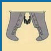
I-Beam durch Schneidmesser geschnitten
