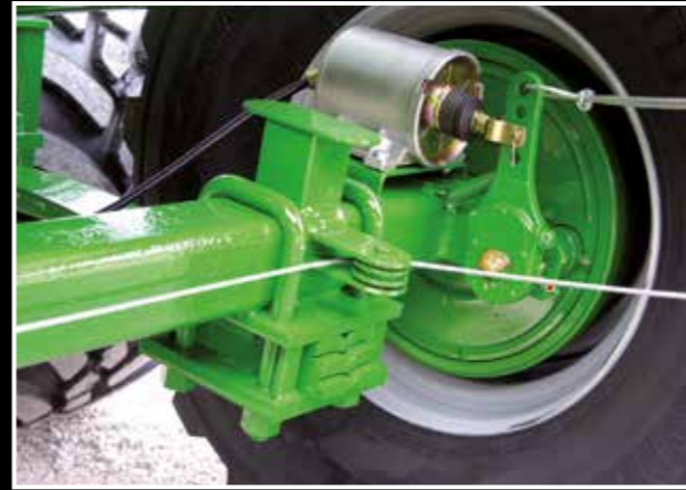
Cilindro freno pneumatico Cilinder pneumatische rem Pneumatic brake cylinder Cylindre frein pneumatique Pneumatischer Bremszylinder
