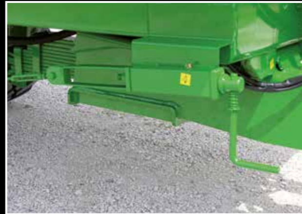
Freno Parking meccanico tipo Italia per biassi Mechanische parkeerrem type Italië voor dubbele as Italian-type mechanical parking brake for dual axels Frein de stationnement mécanique type Italie pour double essieu Mechanische Feststellbremse Typ Italien für Doppelachser
