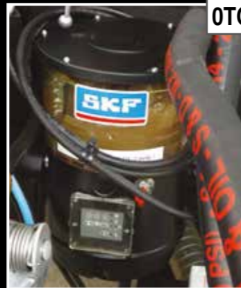
Lubrificazione per assali con pompa elettrica (50 punti) solo per assali e sospensioni idrauliche Electrische centrale smering (50 punten) programmeerbaar alleen voor assen met hydraulische vering. Lubrification electrical system (50 points) programmable only for axles and hydraulic suspensions Système de lubrification électrique programmable (50 point) pour essieux etsuspension hydraulique elektrische und elektronische Schmieranlage mit (50 punkten) für Achsen und hydraulische Aufangung
