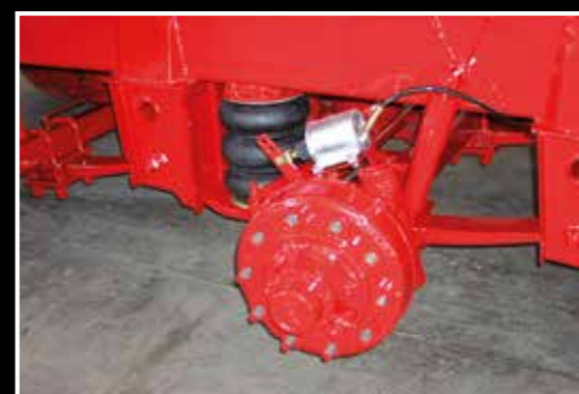
Sospensione tridem pneumatica Pneumatische Tridem-ophanging Pneumatic Tridem suspension Suspension Tridem pneumatique Pneumatische Tridemaufhängung
