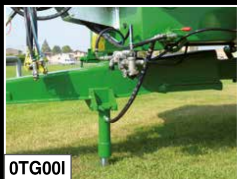
Ribaltamento tubo dev./Piede idr. S.E. Hydraulische steunpoot opklapbaar Tipper deviator tube/simple effect hydraulic foot Capotage tube déviateur/pied hydraulique S.E. Umlenkrohr Kippvorrichtung/einfach wirkender Hydraulikstützfuß
