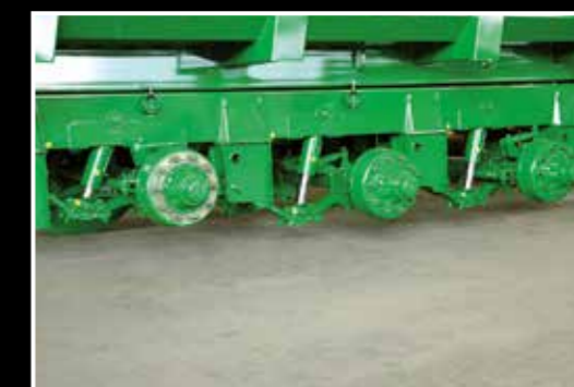
Sospensione Tridem Idraulica Hydraulische Tridem-ophanging Hydraulic Tridem suspension Suspension Tridem Hydraulique Hydraulische Tridemaufhängung
