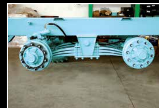
Sospensione Cantilever parabolica Parabolische Cantilever-ophanging Parabolic Cantilever suspension Suspension Cantilever parabolique Parabolische Cantilever-Aufhängung
