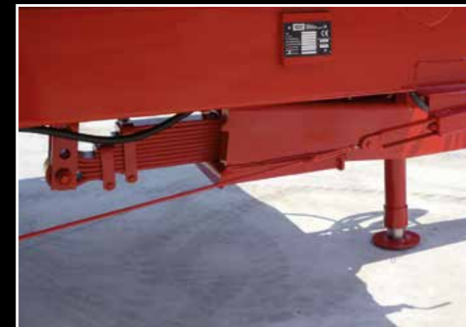
Timone con balestra Handrem met spinde Rudder with leaf spring Flèche avec ressort à lames Grindel mit Blattfeder
