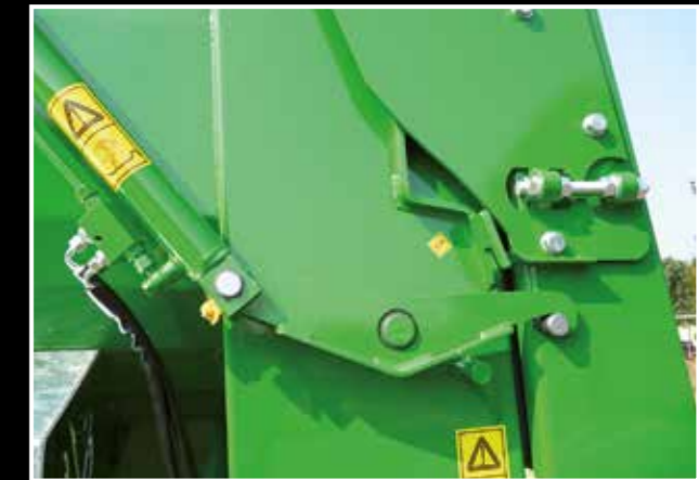
Partic. Porta idr. con gancio meccanico di blocco Detail hydraulische deur met mechanische blokkeringshaak Detail of hydraulic gate with mechanical clamp Détail de la porte hydraulique avec enclenchement mécanique de verouillage Detail der Hydrauliktür mit mechanischem Befestigungshaken
