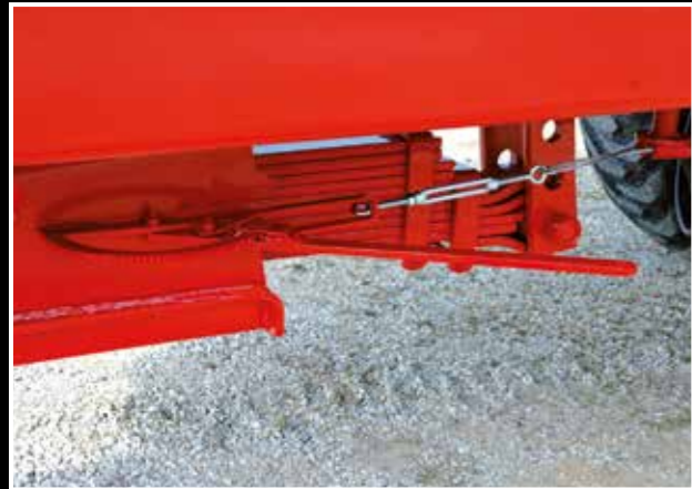
Freno Parking tipo Francia Parkeerrem type Frankrijk French-type parking brake Frein de stationnement France Feststellbremse Typ Frankreich
