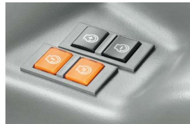
Zapfwellenarbeiten erledigen Sie mit dem NEXOS besonders einfach – dank des serienmäßigen Motordrehzahl Speichers.
