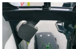
Eine Kabeldurchführung nach vorn und hinten in der Kabine sowie eine Anbauschiene an der rechten Tür erleichtern die Installation externer Bedieneinheiten von Anbaugeräten.
