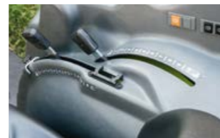
Sie haben die Wahl zwischen der mechanischen und der elektronischen Heckkraftheberregelung. Beide sind ergonomisch günstig rechts neben dem Fahrersitz platziert.
