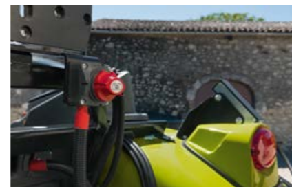
Der Batterietrennschalter befindet sich am hinteren Teil der Kabine und ist leicht erreichbar.
