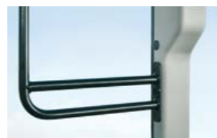
Eine Kabeldurchführung nach vorn und hinten in der Kabine sowie eine Anbauschiene an der rechten Tür erleichtern die Installation externer Bedieneinheiten von Anbaugeräten.
