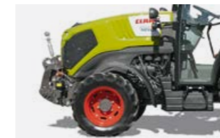
Der klappbare Frontkraftheber ermöglicht durch geringen Überhang sichere Wendemanöver am Vorgehende.
