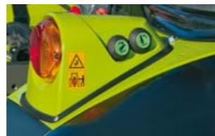
Komfortable externe Bedienung bei mechanischem oder elektronischem Heckkraftheber
