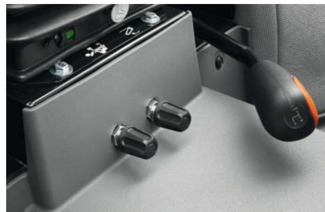
Auch bei dem mechanischen Heckkraftheber lassen sich die Senkgeschwindigkeit und die Empfindlichkeit der Zugkraftregelung unter dem Fahrersitz feinstufig einstellen.
