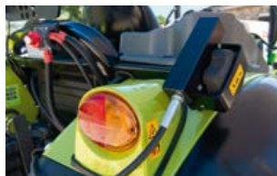
Komfortable externe Bedienung bei mechanischem oder elektronischem Heckkraftheber
