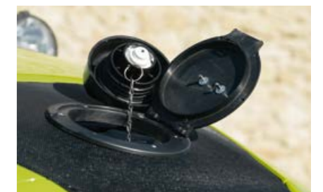
Praktisch ist die hochstellbare Öffnung in der Motorhaube. So lässt sich der geschützt darunterliegende Tank leicht öffnen und füllen.
