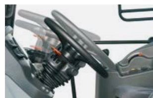
Die schwenk- und teleskopierbare Lenksäule lässt sich an die Sitzposition des Fahrers anpassen.
