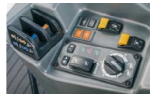
Sie haben die Wahl zwischen der mechanischen und der elektronischen Heckkraftheberregelung. Beide sind ergonomisch günstig rechts neben dem Fahrersitz platziert.
