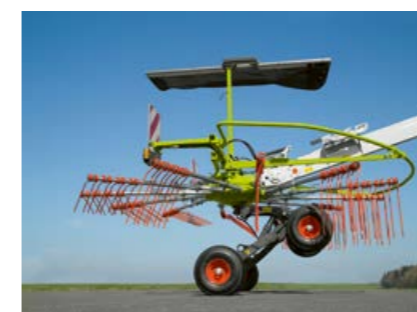
Hauteur de relevage élevée pour le franchissement des andains en fourrière : jusqu'à 50 cm pour le LINER 700 TWIN.
