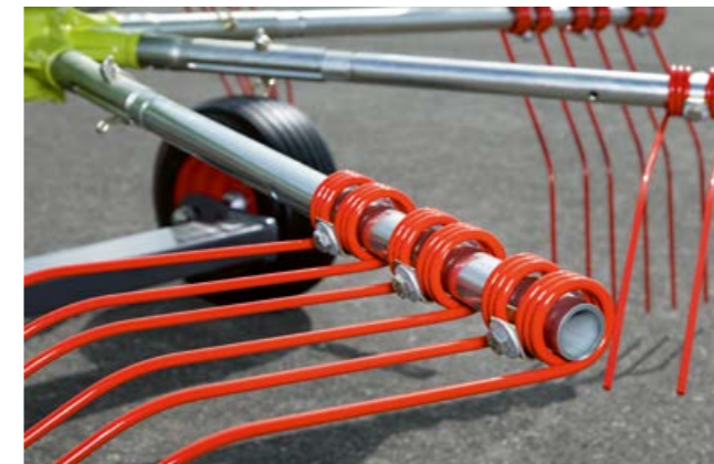
Les bras porte-dents se démontent sans outil.
