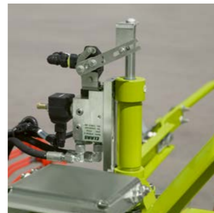
En version confort, les deux andaineurs à quatre rotors possèdent un réglage électro-hydraulique de la hauteur de travail.
