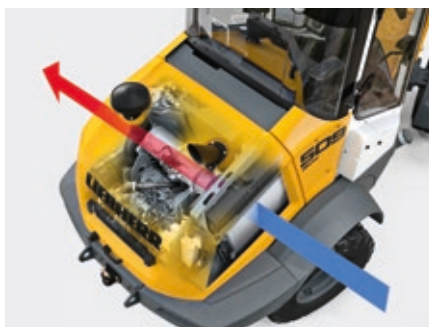
Kühlanlage L 507/L 509
