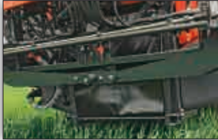
Anti-fouettement indépendant des bras droit et gauche de la rampe pour une meilleure pulvérisation à haute vitesse.
