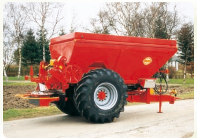
K105 с шинами 800/65 x 32, расширителем бункера, дозированием с гидравлическим управлением, резервным оборудованием, задействуемым от трансмиссии, и шириной полосы разбрасывания 12-16 м для извести и 12-24 м для удобрения.
