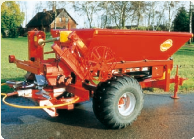
K40 с шинами 425/65 x 22,5 и оборудованием для разбрасывания извести на ширину полосы 12-16 м и удобрения - на ширину полосы 12-24 м.
