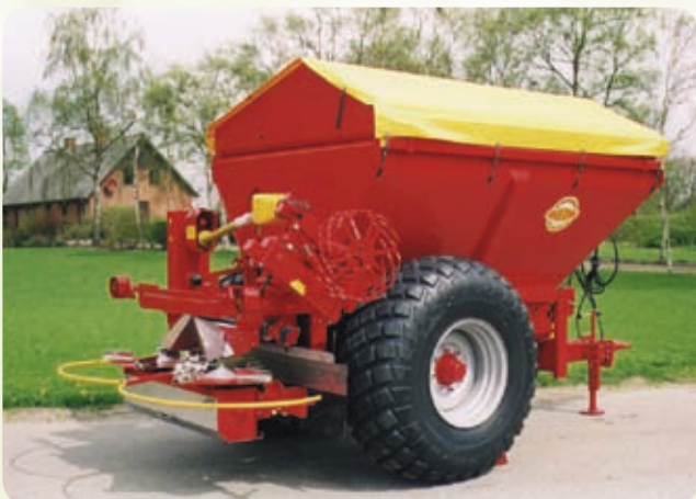
K45 с шинами 16,9 x 30, оборудованием для разбрасывания удобрений на ширину полосы 12-36 м, расширителем бункера, разбрасывающей системой, закрытой крышкой и дозированием с гидравлическим управлением.
