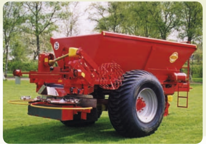
K85 с шинами 650/65 x 30,5 и оборудованием для разбрасывания извести на ширину полосы 12-16 м и удобрения - на ширину полосы 12-24 м.
