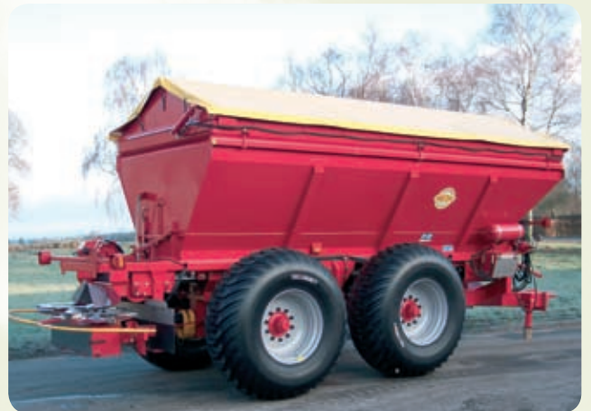
K135 avec des pneus 650/65 x 30,5, équipement chaux 12-16 m / engrais 12-24 m et extension de trémie à carter hydraulique. De série, le modèle K135 est doté d'une commande de dosage hydraulique par ordinateur BREDAL LH500.
