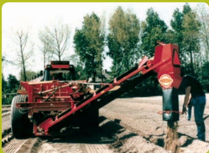
Distributeur de sable BREDAL. À monter sur les modèles K45 à K105.
