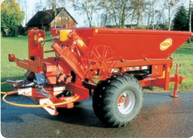
K40 avec des pneus 425/65 x 22,5, équipement chaux 12-16 m / engrais 12-24 m.
