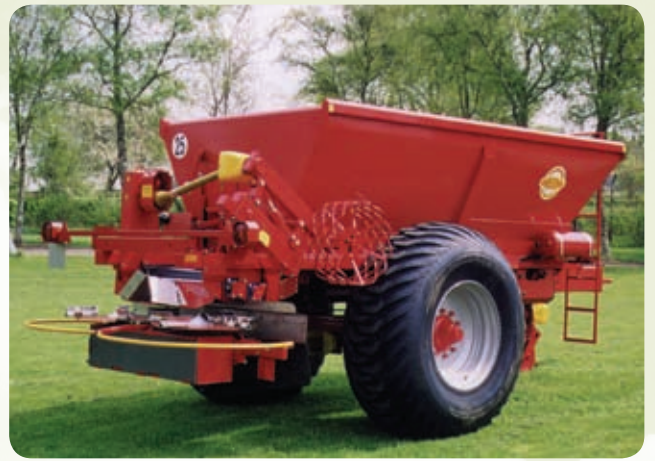
K85 avec des pneus 650/65 x 30,5, équipement chaux 12-16 m / engrais 12-24 m.
