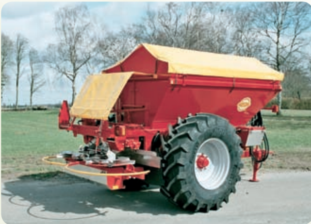
K45 avec des pneus 16,9 x 30, équipement engrais 12-36 m, extension de trémie, carter pour le système d'épandage et dosage à commande hydraulique.
