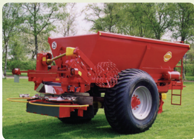
K85 s pneu 650/65 x 30.5 a disky pro rozmetání vápence 12 – 16 m /průmyslových hnojiv 12 – 24 m.
