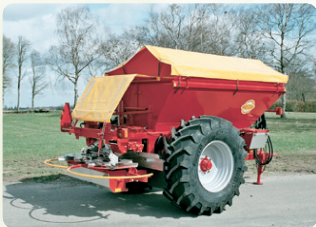
K45 s pneu 16.9 x 30 a disky pro rozmetání prům. hnojiv 12 – 36 m, s nástavcem zásobníku, krytem rozmetacího systému a hydraulicky ovládaným dávkováním.
