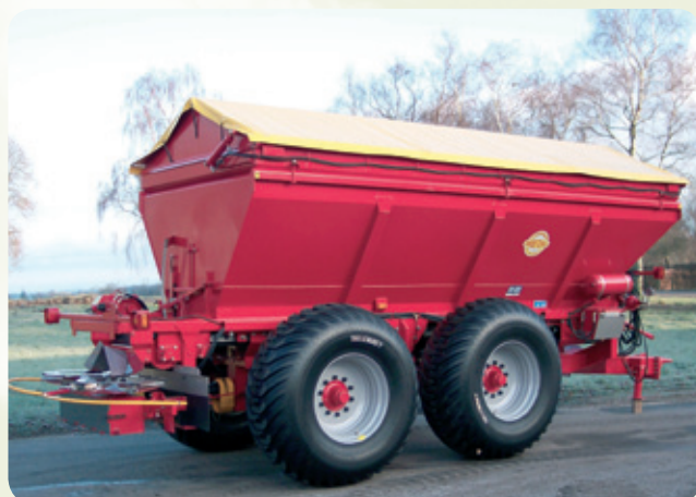
K135 s pneu 650/65 x 30.5 a disky pro rozmetání vápence 12 – 16 m /průmyslových hnojiv 12 – 24 m a s nástavcem zásobníku a s hydraulicky ovládaným krytem. K135 je standardně vybaveno hydraulicky řízeným dávkováním prostřednictvím počítače Bredal LH500.
