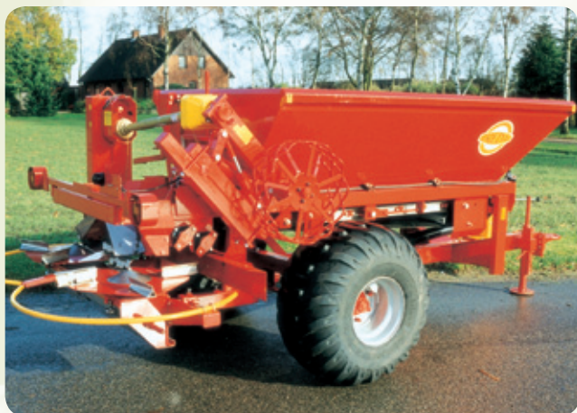
K40 s pneu 425/65 x 22.5 a disky pro rozmetání vápence 12 – 16 m /prům. hnojiv 12 – 24 m.
