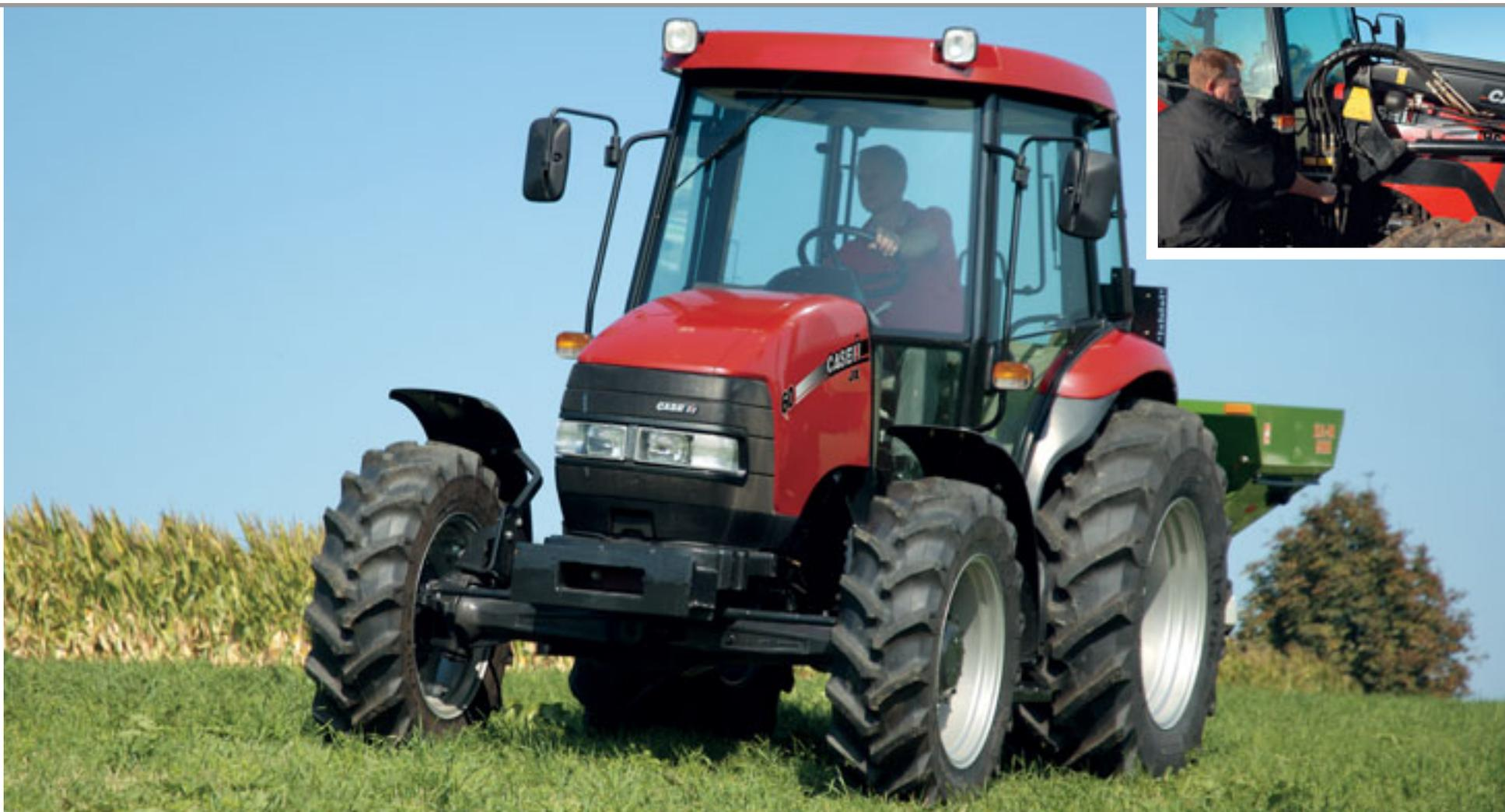
► **Maniobrabilidad en el campo y en las labores de interior.** Su extraordinario ángulo de giro, oscilación del eje y corta distancia entre ejes, garantizan la máxima agilidad del tractor.
