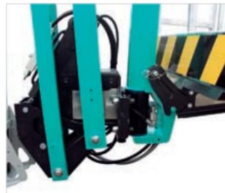
Kompakte Einheit von Korbbarm, Korbdrehung und Lastzelle
