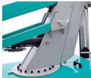
Im Hauptarm sicher untergebrachte Hydraulikkomponenten für die Plattformeinheit
