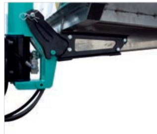
Korbaufhängung für einfache und unkomplizierte Demontage/Montage des Arbeitskorbes
