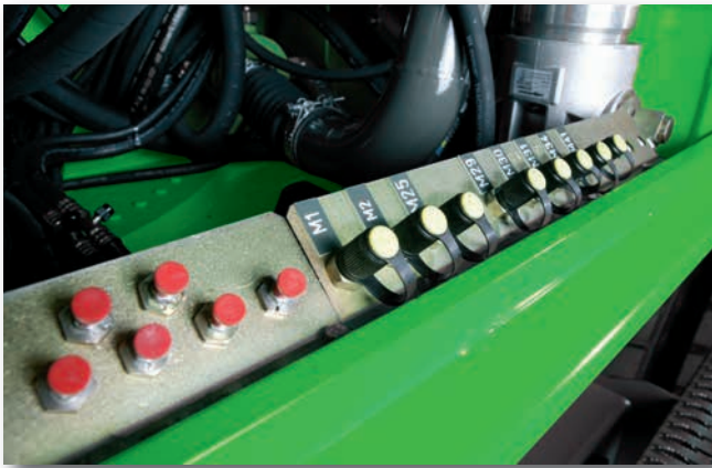
Zentrale Messpunkte zur einfachen und schnellen Überprüfung der gesamten Hydraulikanlage
