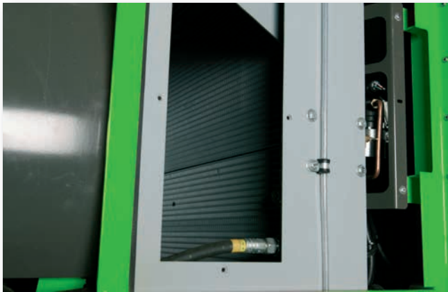
Eine Kühlbox mit 3-Kreis-Kühlsystem für Ladeluft-, Wasser- und Ölkühlung
