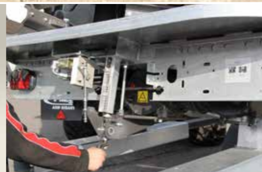
Rychlost dopravy materiálu se reguluje pomocí automatické regulace posuvu
