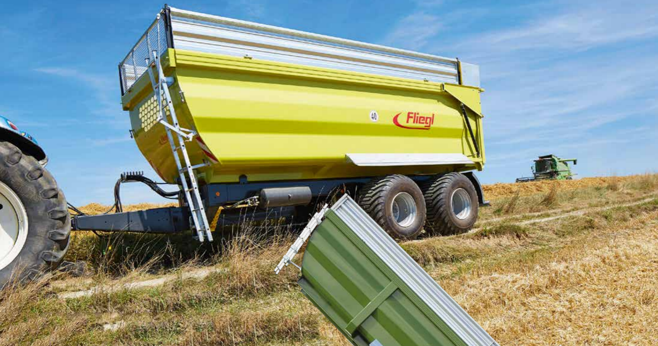
Tandemový sklápěč TMK 378 Profi s délkou korby 7,80 m a úhlem sklápění přibližně 55°
