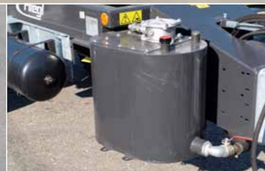
Palubní hydraulika s pohonem kloubovým hřídelem – volitelně
