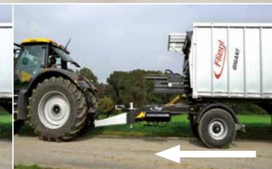
Hydraulické posouvání sedlové plošiny pro jednonápravové a tandemové přívěsy Dolly
