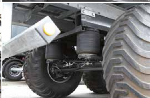
Volitelně: Vzduchové odpružení s automatickým spuštěním při sklápění
