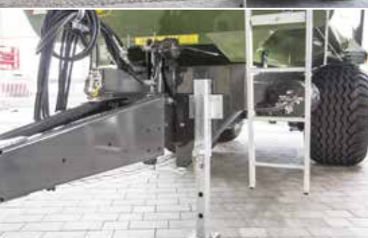
Obr. nahoře: Mechanicky sklopná ochranná mříž
