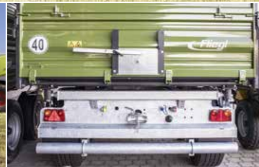
Provedení 40 km/h s ochranou proti podjetí a blatníky
