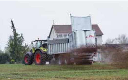
Nahoře: Rozmetadlo PROFI V2 s rozmetacím talířem a vyhazovacím kyvadlem
