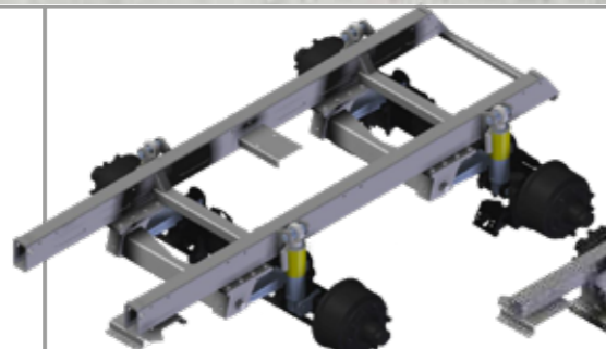
Hydraulické pružení náprav přímo u země
