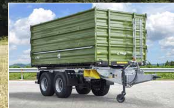
TDK 160 s nastavbou 1800 mm (bočnice 3 x 600 mm)
