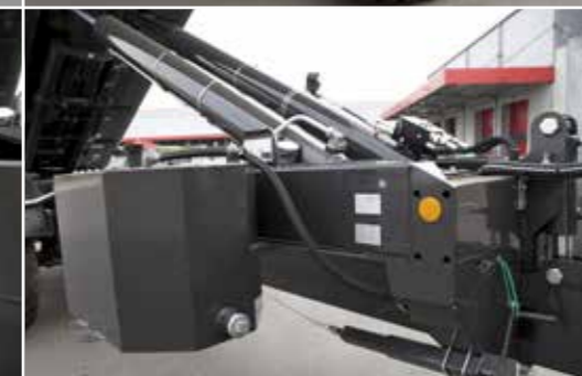
Palubní hydraulika 60 litrů (volitelně 90 l) poháněná vývodovým hřídelem s hydraulickým čerpadlem a olejovou nádrží
