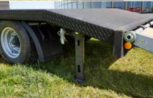
Nahoře: Nájezdová rampa sériově s pružnou pákou a volitelně také hydraulicky ovládaná
