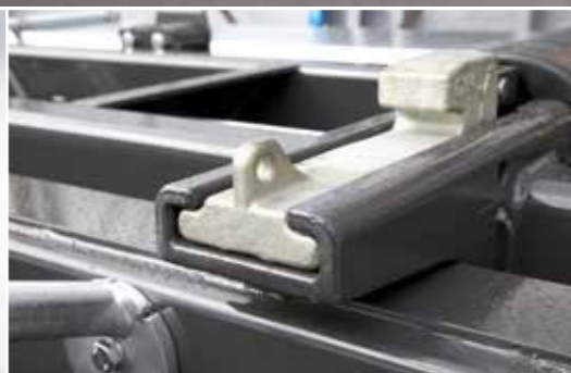
Systém zajištění se zásuvnými zámky pro zajištění zevnitř i zvenčí
