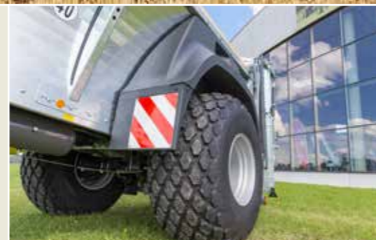
Volitelně: Provedení 40 km/h s blatníky u modelů ADS 80 / ADS100 / ADS120
