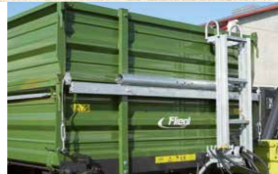
Volitelně: Tažná pružina bočnic v těžkém provedení
