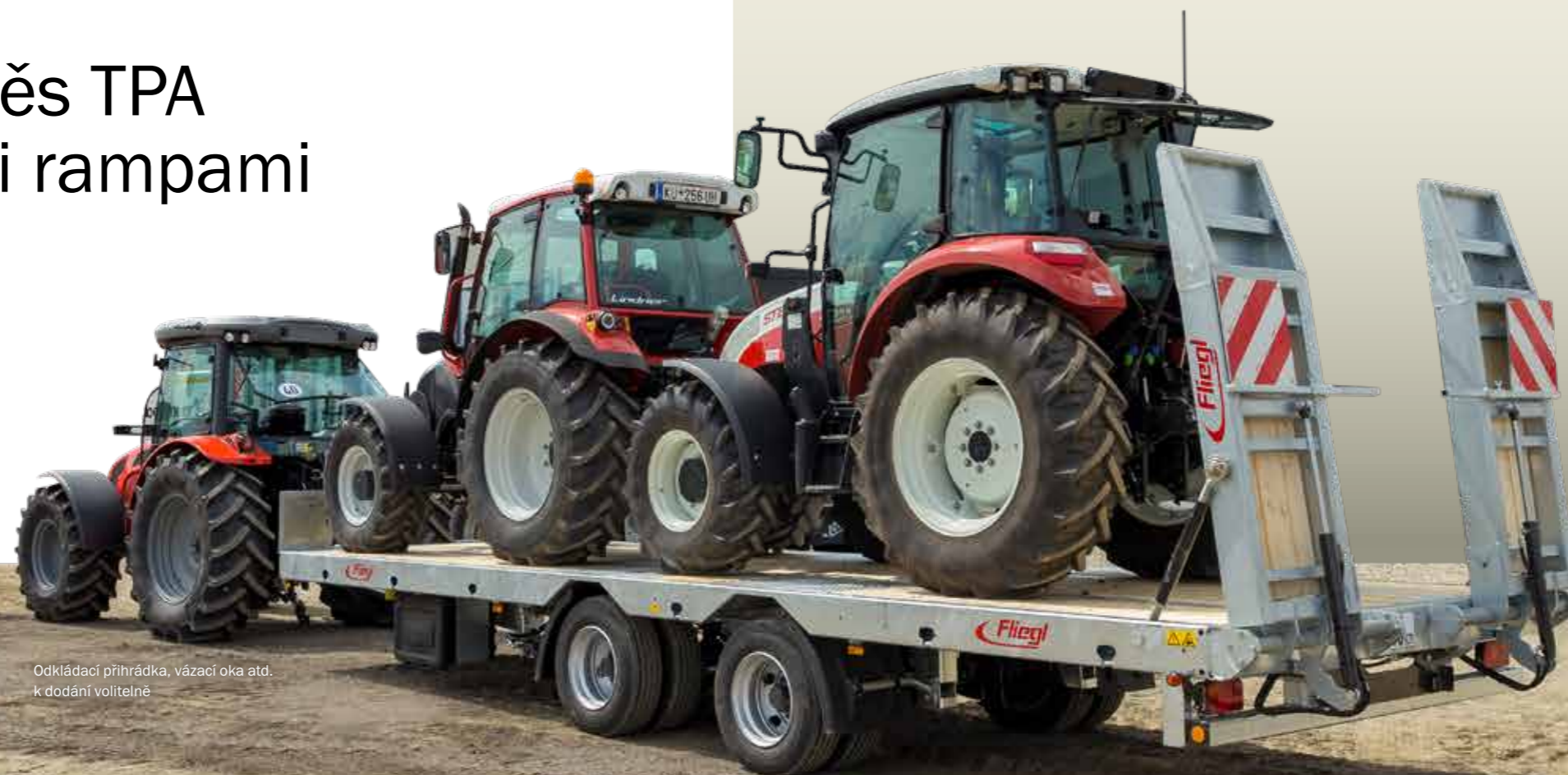
Volitelně: Nájezdové rampy, sklopné hydraulicky
