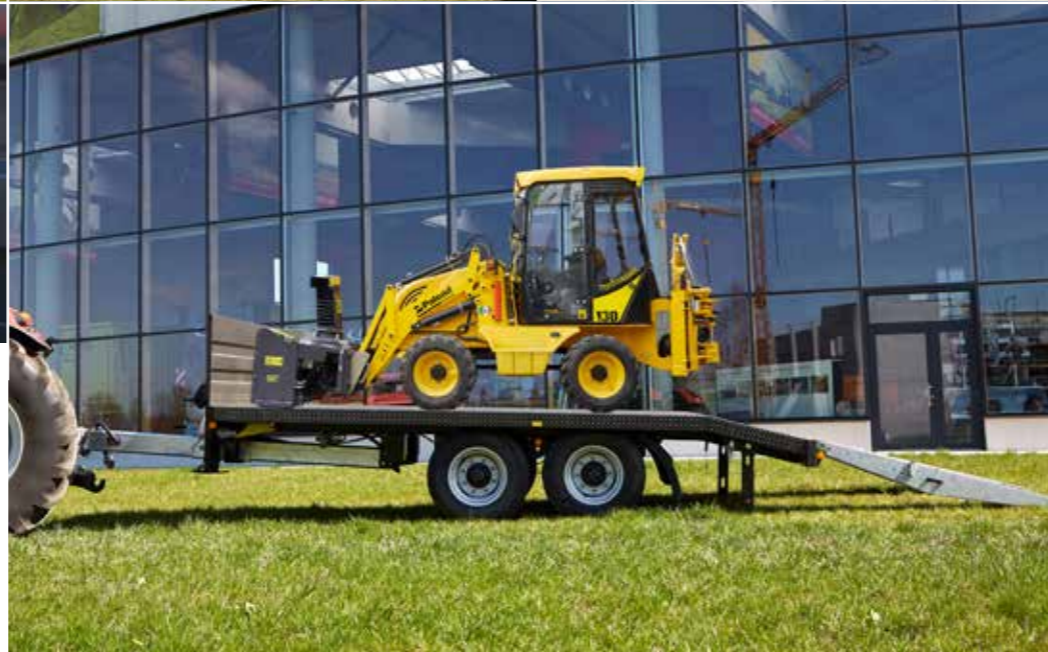
Nájezdové rampy obložené dřevem, dno plošiny z ocelového plechu 3,5 mm lakovaného u TPA 120
