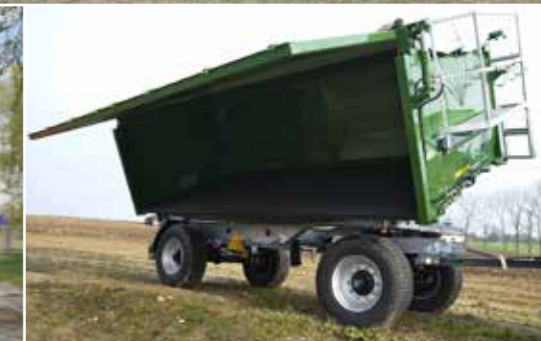
ZDMK 200 Profi s hydraulickým otevíráním bočnic
