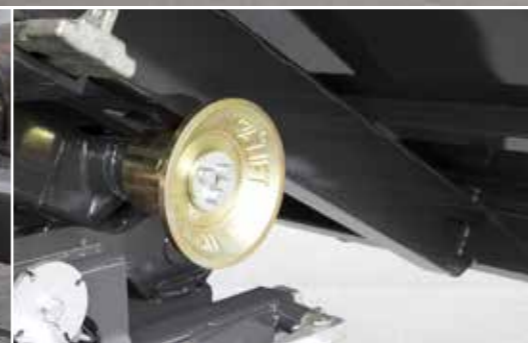
Velké výstupní válce z ocelolitininy (Ø 310 mm) s velkou středící tyčí usnadňují natažení kontejnerů.
