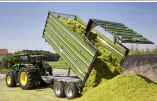
Silážní sklápěč s hydraulickou zadní stěnou
