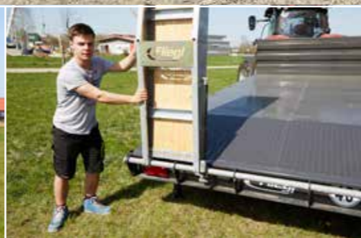
Praktické: Posuvné nájezdové segmenty k přizpůsobení rozchodu kol
