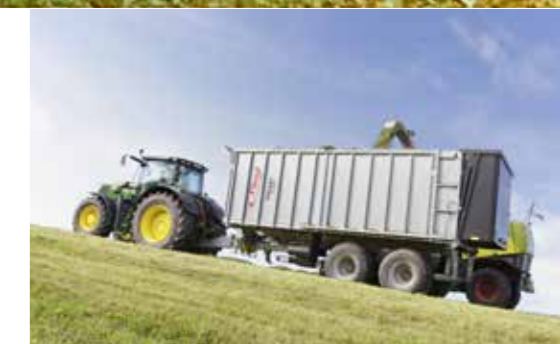
Příznivé umístění těžiště díky nízké konstrukci
