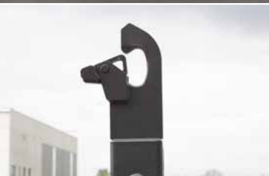
Kovaný, snadno vyměnitelný nosný hák
