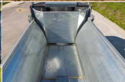
Nejmenší opotřebení díky hydraulickému systému posuvu – žádné drapákové dno.
