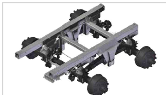
Tandemový agregát Titan pro nejlepší vyrovnávání dna, bez nutnosti promazávání a údržby.
