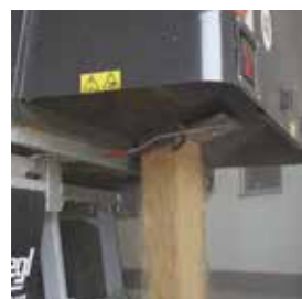
Velkoobjemová zadní stěna se shrnovačem obilí
