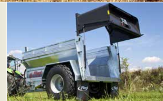
Systém ADS lze volitelně vybavit velkoprostorovou zadní stěnou 800 mm a využít jej jako přepravní přívěs
