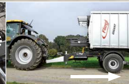
Hydraulické posouvání sedlové plošiny pro jednonápravové a tandemové přívěsy Dolly
