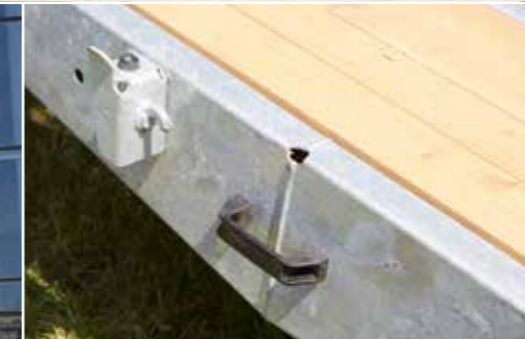
Nájezdové rampy obložené dřevem, dno plošiny z ocelového plechu 3,5 mm lakovaného u TPA 120
