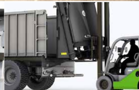
S vysokozdvížným vozíkem jsou všechna rozmetadla namontována snadno během cca 20 minut.
