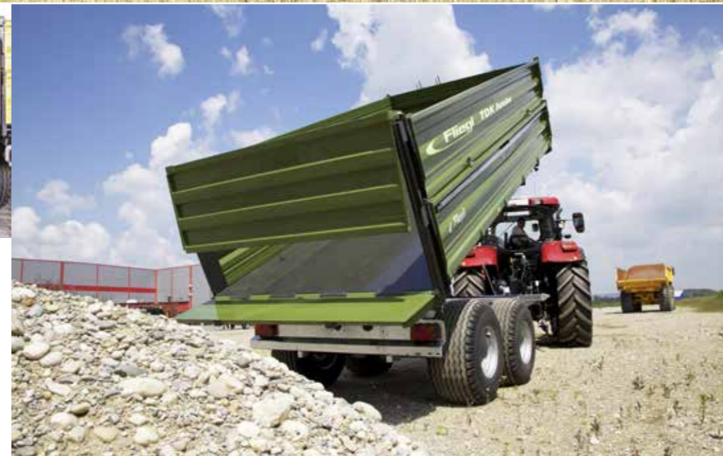
TDK 160 s nastavbou 1800 mm (bočnice 3 x 600 mm)
