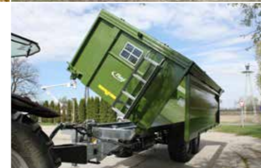
Tandemový trojstranný korbový sklápěč, extrémně robustní díky zesílené boční stěně.
