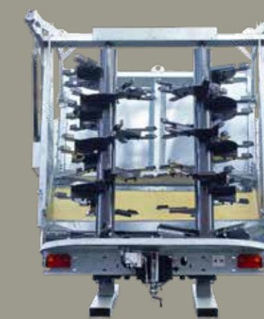
Frézovací válec s rozmetacími lopatkami
