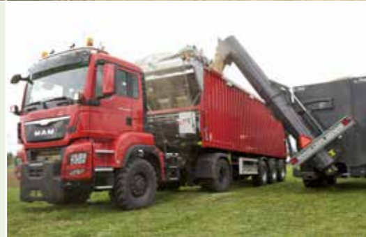
Nahoře: Překládací šnekový dopravník ŮLS 400 na obilí Výkon překládání cca 7,5 t/min
