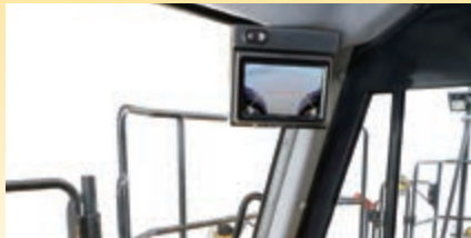
L'écran séparé pour la vue arrière peut rester allumé en permanence (uniquement en marche arrière)
