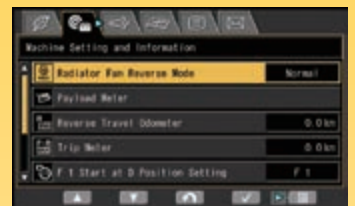
Mode du ventilateur de refroidissement
