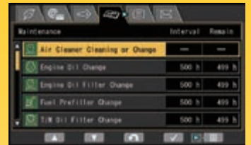
Écran de base de maintenance
