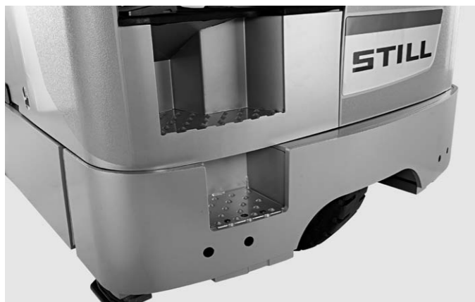
Sicherer Aufstieg durch zusätzliche Trittstufe
