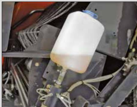
Чтобы обеспечить долгий срок службы цепей на пресс-подборщиках с фиксированной камерой, машины KUHН FB могут быть оснащены системой смазки цепей, которая включается на каждом цикле обвязки. Система смазки цепей является стандартной возможностью на модели FB 2130 и доступна как дополнительное оборудование на FB 119.
