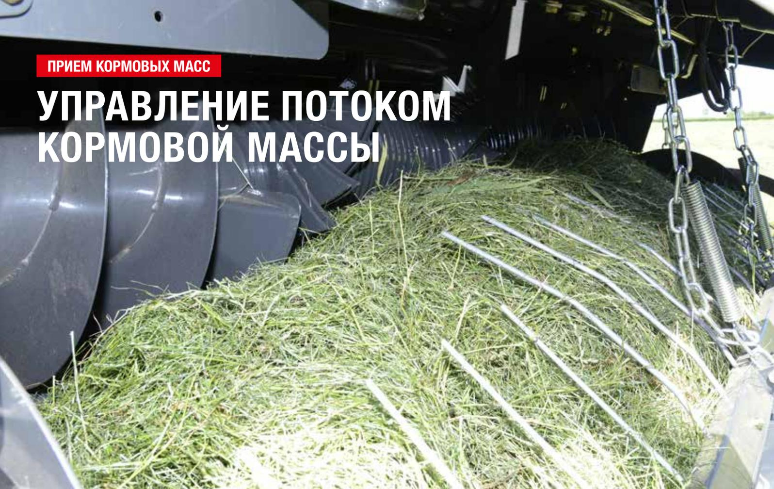
**Пресс-подборщики KUNN FB обеспечивают оптимальный прием кормовых масс. Широкий кулачковый блок подбора на моделях с роторным приемом максимально адаптируется к земле благодаря маятниковому механизму, который позволяет работать в самых сложных условиях.**
