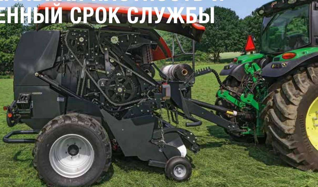
**Прочный привод с новой конструкцией редуктора представляет собой раздаточный привод. Привод камеры прессования на одной стороне и привод ротора и подборщика на другой обеспечивают плавность работы и равномерную передачу мощности. Главный привод и цепи роликов пресс-подборщика изготовлены из высокопрочных цепей 100Н (1¼), обеспечивающих увеличенный срок службы.**
