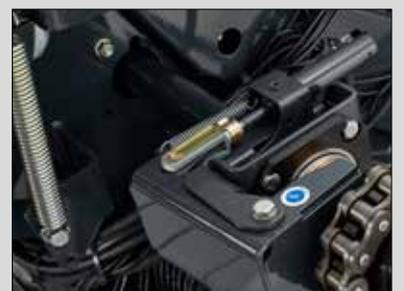
*Гидравлическое отключение ротора*
