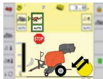
Vista automática del proceso de la compuerta trasera
