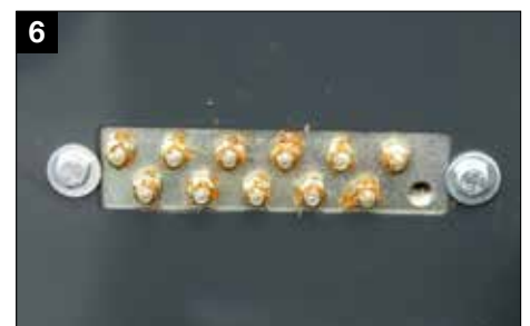
6 Bancos de lubricación centralizados para los rodamientos de los rodillos
