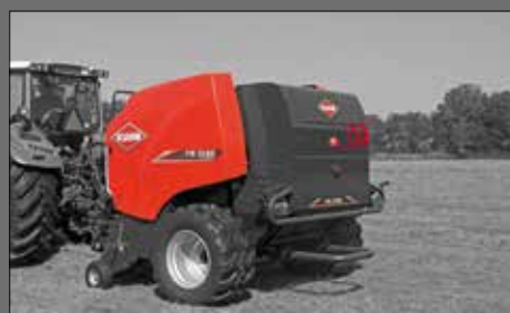
Mientras se aplica el atado con malla, se activan las señales visuales y acústicas de la empacadora
