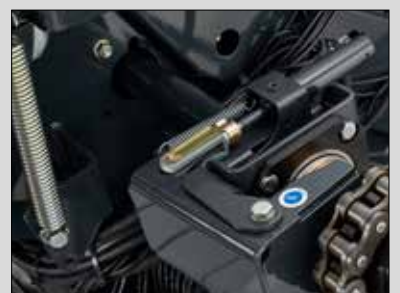
Desacoplamiento hidráulico del rotor
