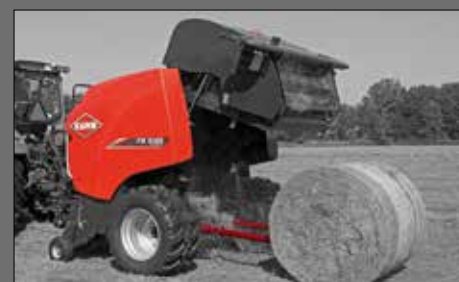
El volcador de pacas detecta cuando la paca está fuera de alcance. La compuerta trasera no se abre más de lo necesario. La compuerta trasera se cierra automáticamente
