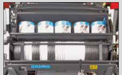
Sistema de atado con cuerda y con malla
