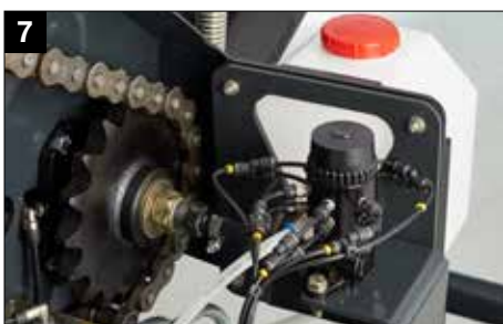
Sistema continuo de lubricación de cadenas BEKA-MAX
