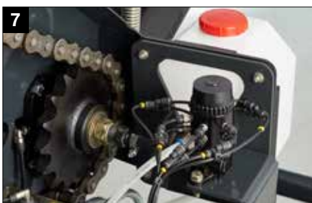
Sistema continuo de lubricación de cadenas BEKA-MAX
