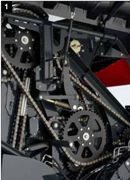
1 Transmisión robusta con cadenas IWIS de alta calidad
