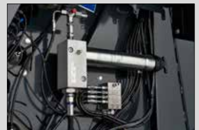
Sistema de lubricación automático para los rodamientos de los rodillos
