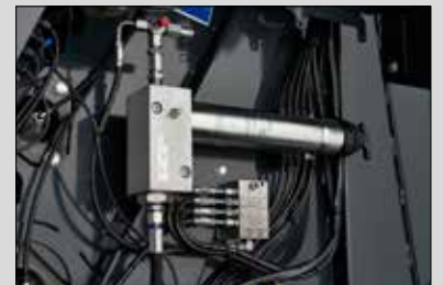
Automatisches Schmiersystem für die Walzenlager
