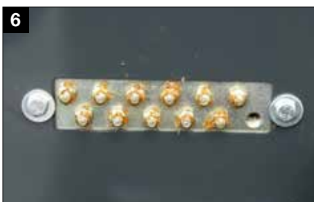
Automatische Kettenschmierung und zentral angeordnete Schmierbänke für die Walzenlager
