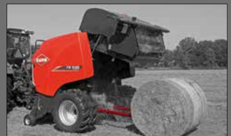
Der Auswerfer registriert, wann der Ballen die Presse verlassen hat. Die Heckklappe öffnet nur so weit wie nötig. Die Heckklappe schließt automatisch
