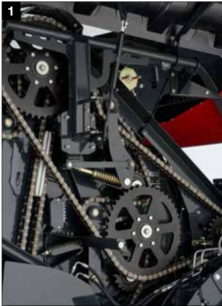
1 Robuster Antrieb mit hochwertigen IWIS-Ketten
