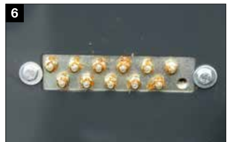
6 Zentral angeordnete Schmierbänke für die Walzenlager
