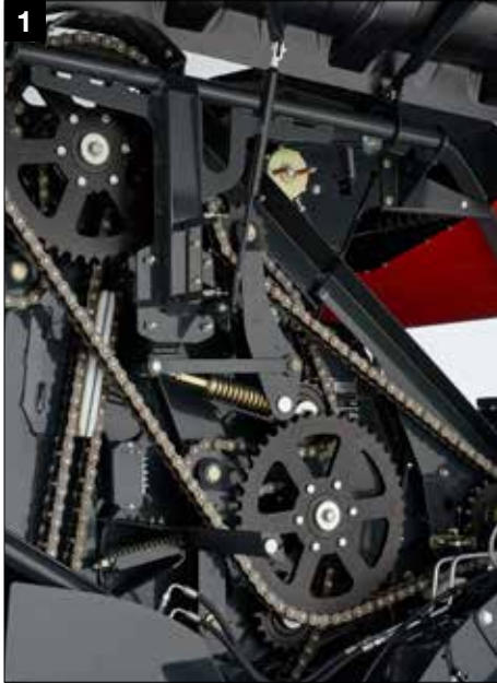
1 Robuster Antrieb mit hochwertigen IWIS-Ketten
