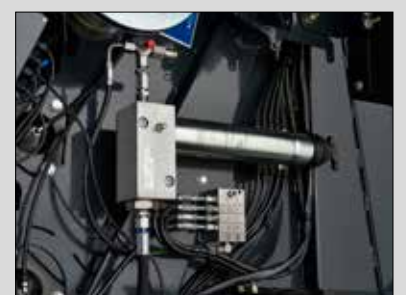
Automatisches Schmiersystem für die Walzenlager
