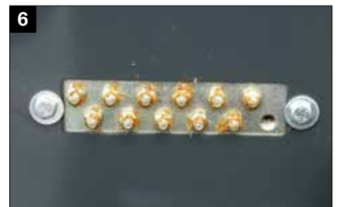
6 Zentral angeordnete Schmierbänke für die Walzenlager
