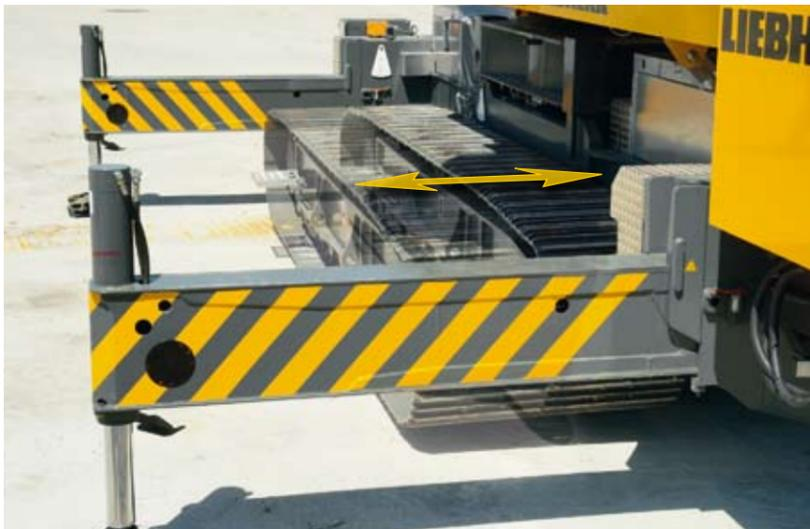
Soddisfa le esigenze pratiche: base di appoggio variabile per lo spostamento in cantiere mediante cingoli a scartamento variabile.
