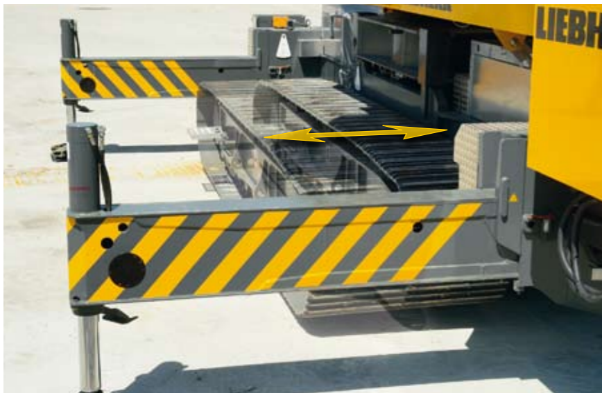
Orienté sur la pratique : base d'appui adaptable pour le déplacement sur le chantier grâce aux chenilles mobiles.
