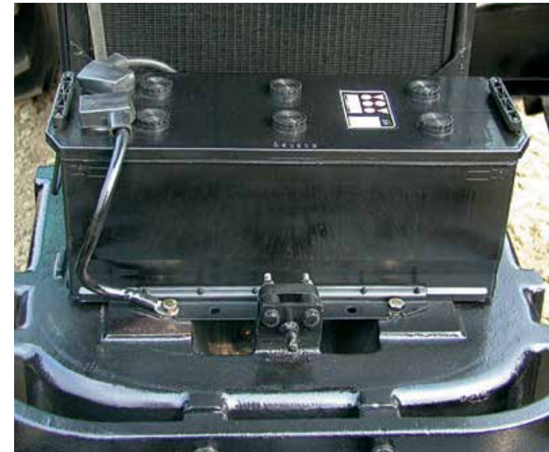
▲ La batería está ubicada debajo del capó del motor, en la parte de adelante del tractor.
