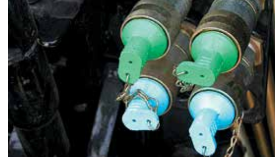
▲ El sistema auxiliar de control remoto ofrece 2 válvulas traseras.
