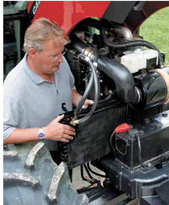
▲ Unidad de condensador amovible que facilita la limpieza
