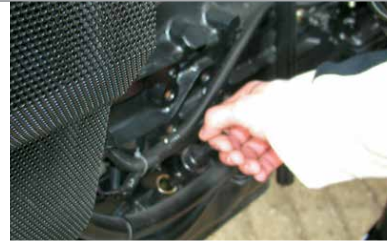
▲ Inspección del aceite del motor sin levantar el capó.
