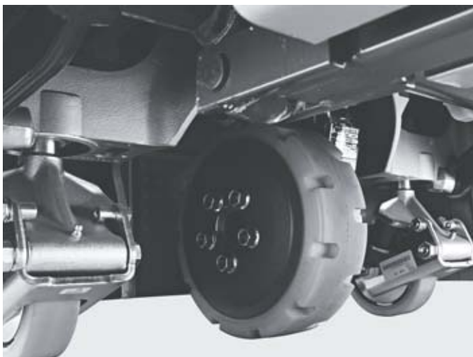
Wytrzymałe podwozie i resorowane koła podporowe gwarantujące efektywną jazdę po rampach
