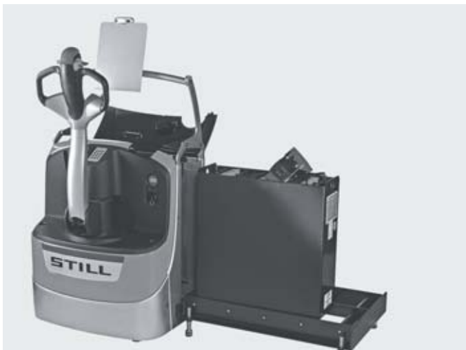
Najwyższa dyspozycyjność dzięki bocznej wymianie baterii
