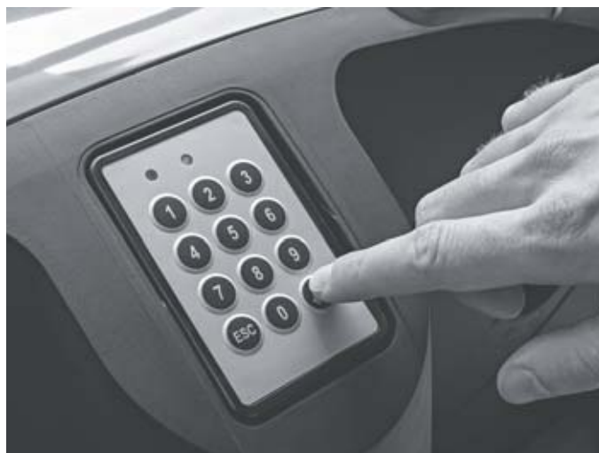
Kontrola přístupu k vozíku volitelně i přes PIN kód
