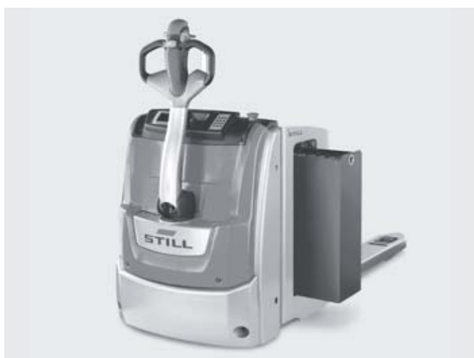
S technologií Li-Ion a kapacitou baterie až 500 Ah je vozík neustále k dispozici
